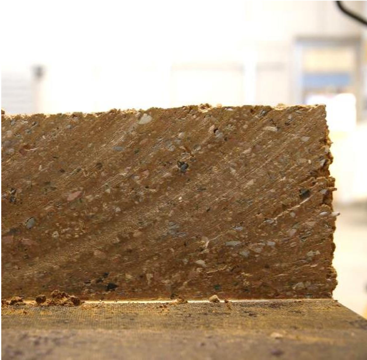
Schnittbild eines erdfeucht bearbeiteten Stampflehmprobekörpers mittels CNC-Kreissäge | ITE/TUBS
