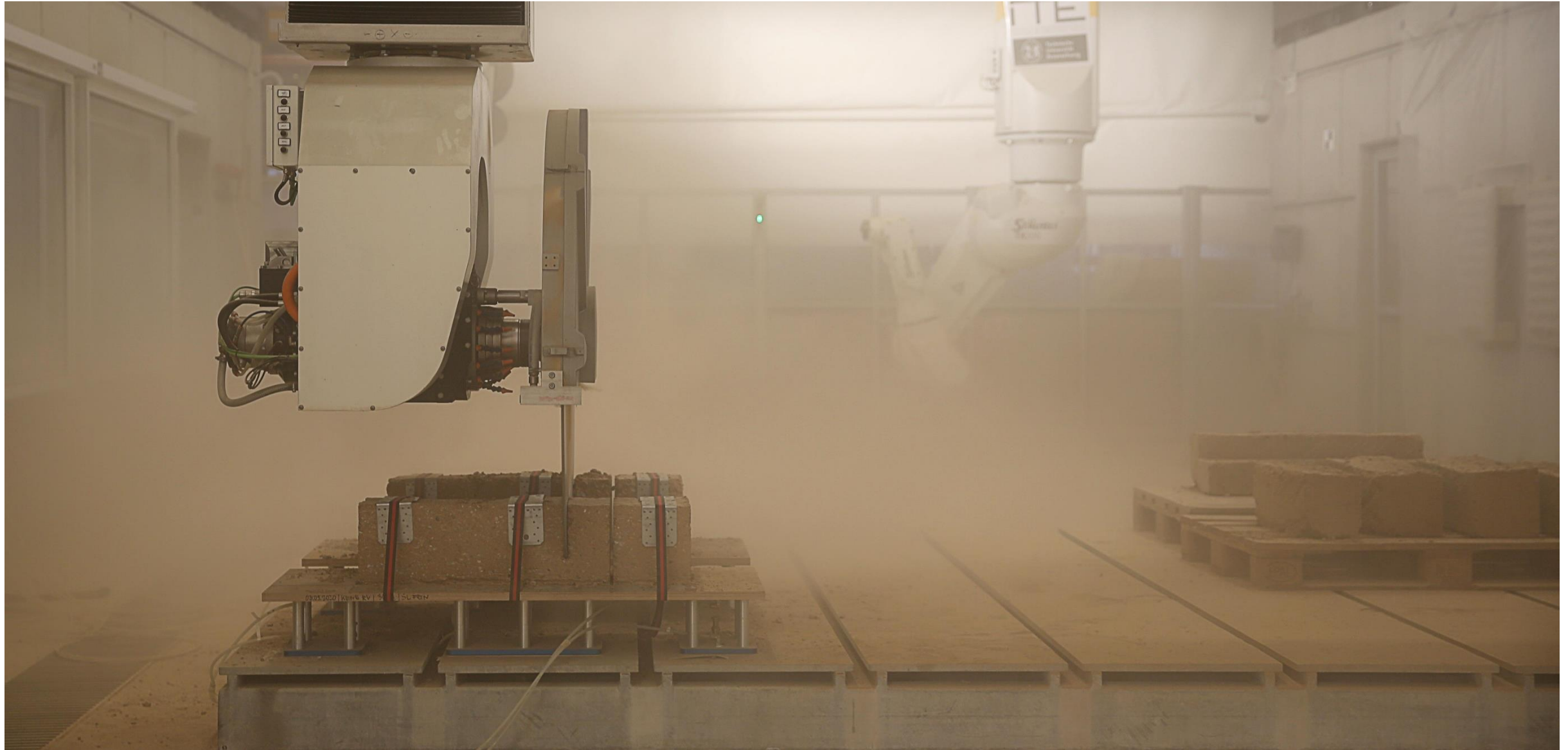
Subtraktive Nachbearbeitung mittels CNC-Kreissäge am DBFL | Abb.: ITE/TUBS
