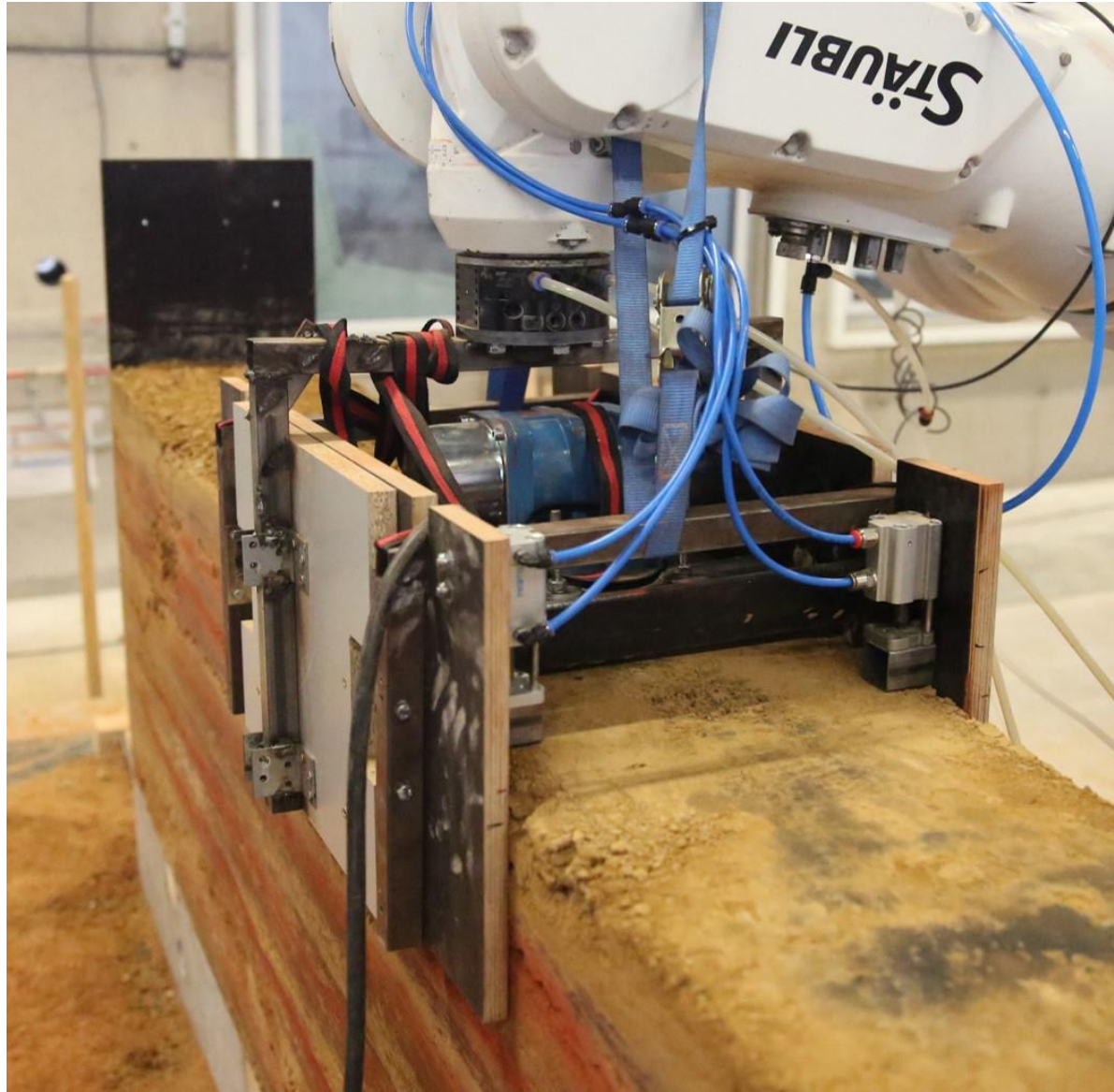
Robotischer Schal- / Verdichtungsprozess | ITE / TU BS
