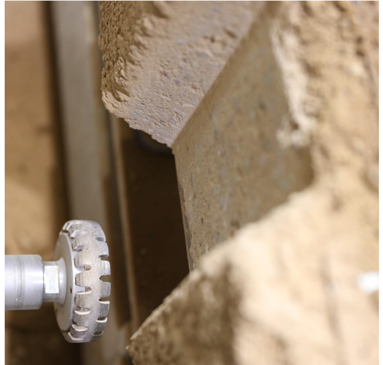
Schnittbild eines trocken bearbeiteten Stampflehmprobekörpers mittels Schleifwerkzeug | ITE/TUBS
